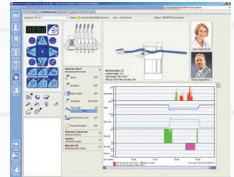
La visualizzazione dell'unità permette il monitoraggio in tempo reale del riunito odontoiatrico prescelto. Ciò può servire per monitorare le attività dell'utente e per rivedere le impostazioni dell'unità.
