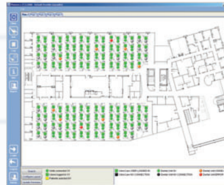
La monitorizzazione della struttura offre una visione d'insieme grafica di tutti i dispositivi collegati nella clinica. Lo stato di ognuno di essi viene così rapidamente valutato, individuando immediatamente quelli che necessitano di assistenza.
